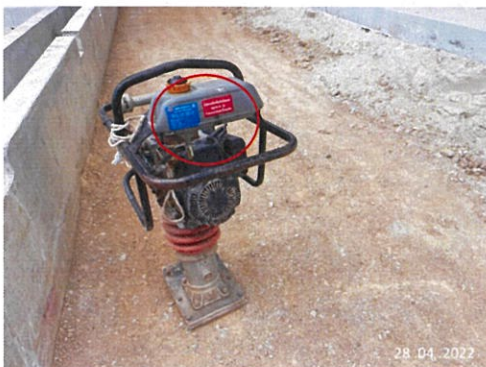
ภาพที่ 2-5 สตาร์ทเตอร์แสดงการตรวจสอบเครื่องยนต์/เครื่องจักร และอุปกรณ์
